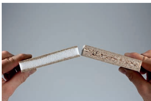
III. 12b Nouveau panneau mis au point avec cœur en mousse (à gauche) comparé à un panneau conventionnel en aggloméré.
