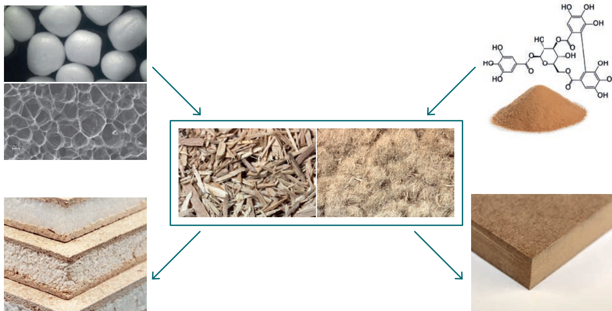
III. 11 Dans le domaine des panneaux en bois (agglomérés/fibres), la recherche est axée sur la mise au point de panneaux plus légers avec cœur poreux en mousse et de colles à base biologique (remerciements à Heiko Thömen).
