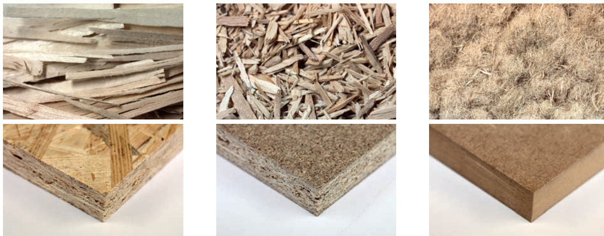
III. 3 Les matériaux ligneux tels que les copeaux ou fibres de bois peuvent être transformés en panneaux aux structures et propriétés diverses. Images de gauche: panneau OSB et copeaux correspondants; images au centre: panneau traditionnel en aggloméré et copeaux correspondants; images de droite: panneau MDF et fibres correspondantes (remerciements à Heiko Thömen).
