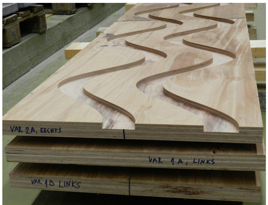
Furnierschichtholzplatten aus Buche mit wellenförmigen Vertiefungen für eine kontinuierliche Verbundwirkung zwischen Beton und Holz
