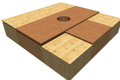
Punktgestützte Flachdecke Quelle: Timbatec GmbH
